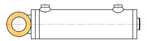
CS End cap with pin mounted ته پوش با پین
