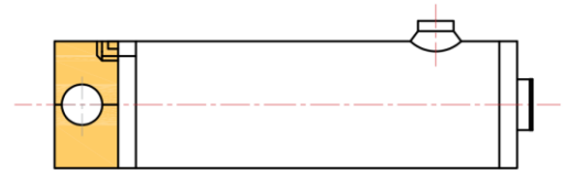
TS Oil inlet hole & pin is on the end cap ورودی روغن و پین‌های پایه روی ته پوش
