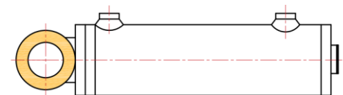
TS Oil inlet hole & pin is on the end cap ورودی روغن و پین‌های پایه روی ته پوش
