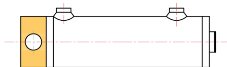
PS Compact end cap with pin mounted ته پوش با پین‌های پایه
